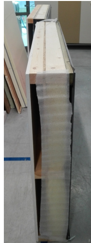
Rys. 1. Próbkę nr 1 - Konstrukcja szkieletowa bez folii refleksyjnej
