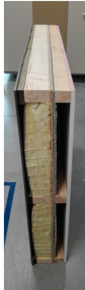
Rys. 2. Próbkę nr 2 - Konstrukcja szkieletowa z folią reflekcyjną
